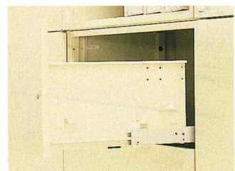
引出しのセーフティロック 1つの引出しを引きはじめると他の引出しが自動的にロックされるので、本体が前に倒れる心配はありません。
