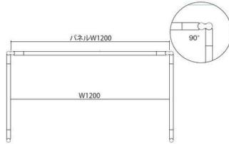
パネルをコの字型にレイアウトした中の有効内寸を最大限に利用したいときは、上記のような組み方にされますと、パネル外寸法通りの内寸が得られます。連結の際は「連結について」をご覧ください。
